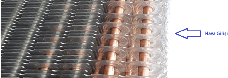
Resim 1: Üç kademeli Hatve uygulaması ( Ör: 8 mm- 16 mm- 24 mm )
