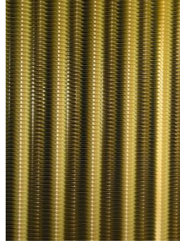
Lamel Pres Hatları ve kalıbına, formuna, hatvesine göre işlenmiş lameller. Dizme ve Şişirme işlemi ile Borulara sıkı temas sağlanmış durum. Ana kanatlı-borulu blok
