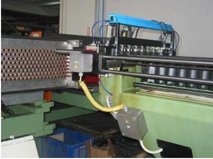
Şekil: 7.1 Boru Şişirme Makinesi ile Bakır Boruların Şişirme işlemi ve Dirseklerin (Kurveler) görünümü
