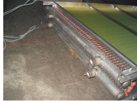
Şekil 9.1 ve Şekil 9.2: Kollektör İşleme Makinesi ve Paslanmaz Giriş-Çıkış Kolektörleri
