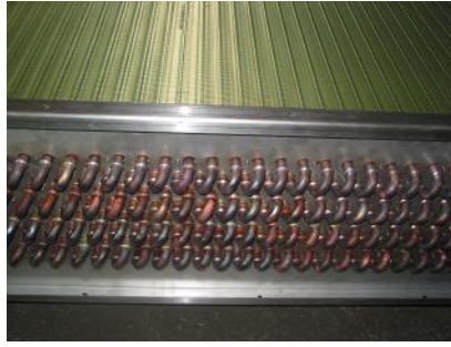
Şekil 7.2-3: Boru Şişirme Makinesi ile Bakır Boruların Şişirme işlemi ve Dirseklerin (Kurveler) görünümü
