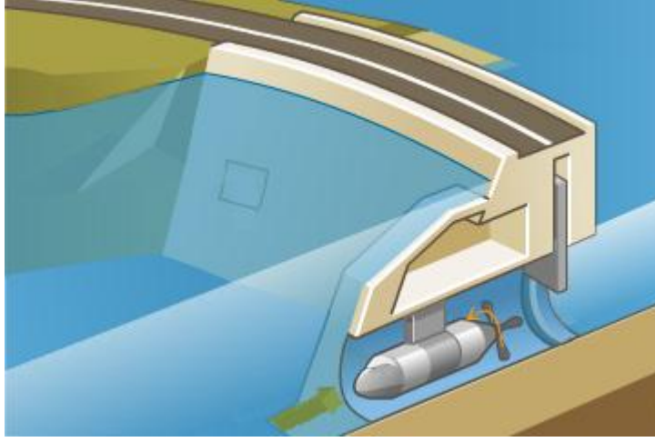
Şekil 10: Gel git barajı boşalırken türbin dönüyor
