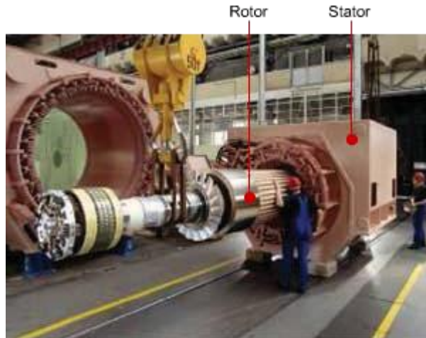
Resim 1: Bir alternatörün statoru ve rotoru
