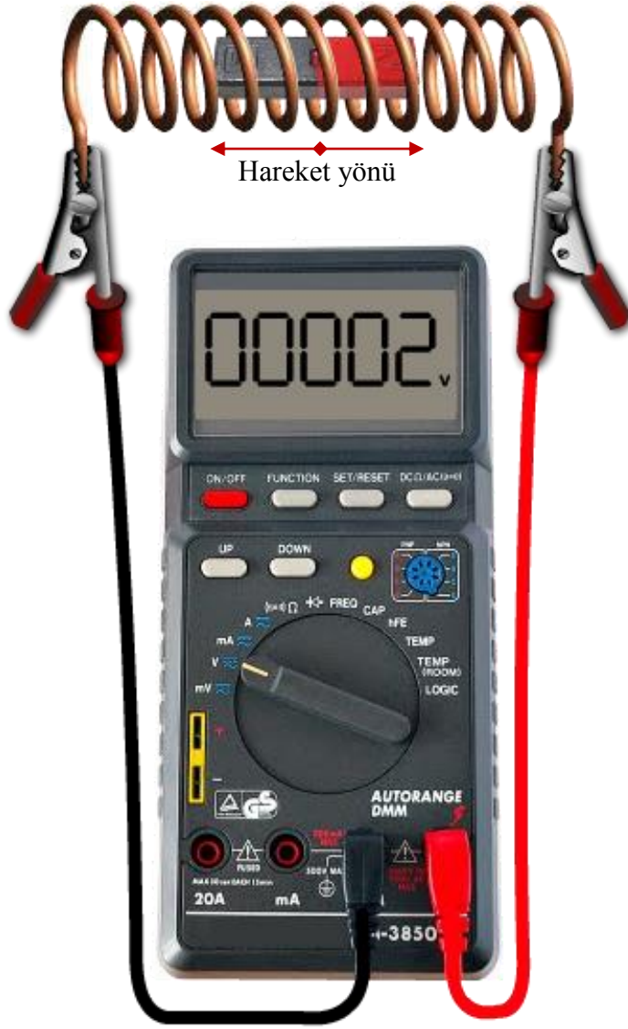
Resim 26: Bir bobinde oluşan gerilim (emk)
