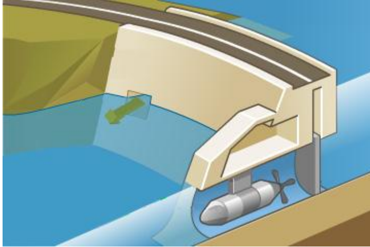
Şekil 9: Gelgit barajı doluyor
