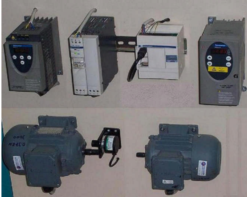
Resim 2.4: AC motor hız kontrol uygulaması
