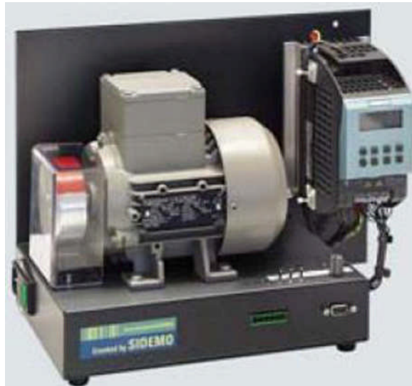
Resim 2.2: AC motor hız kontrol uygulaması
