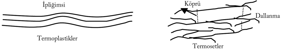
Şekil 1.1 Termoplastik ve termoset malzeme yapısı
