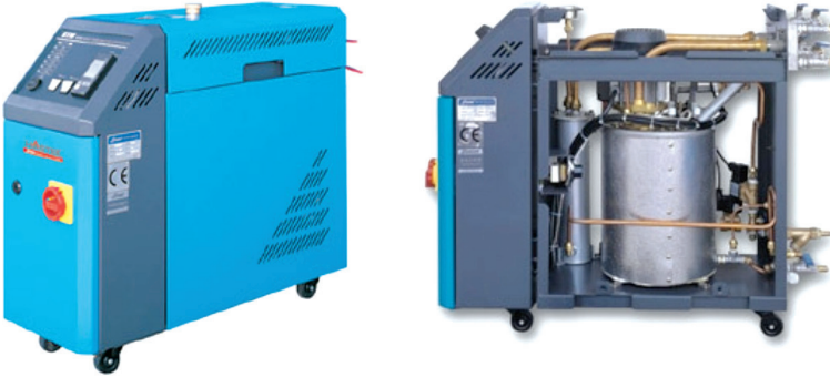
Şekil 1.5 Örnek bir kalıp şartlandırıcısı
