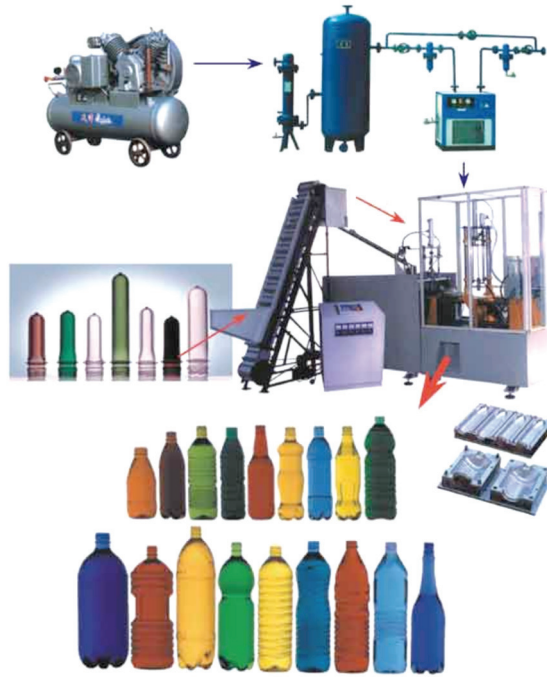
Şekil 1.6 Pet şişe üretimi için hava basınçlandırma şeması
